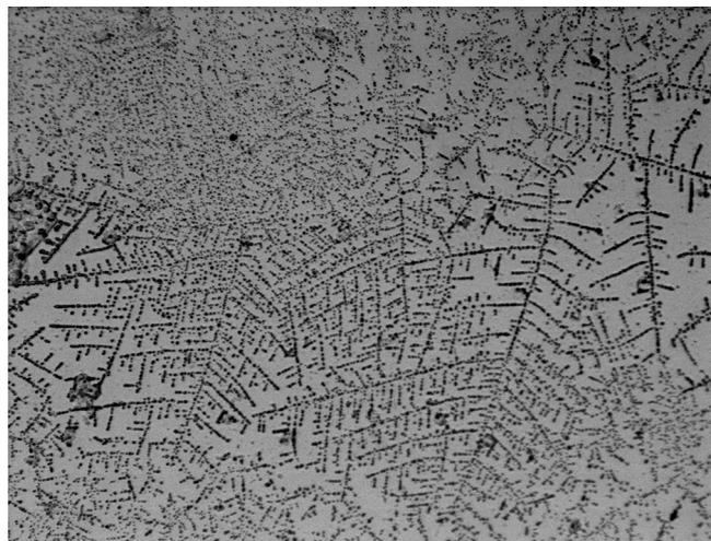
Рис. 8. Кристалл с разрывом структуры CGS.
